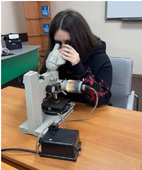
Рисунок 2.9 – Робота з деталю: а – еталографічний оптичний мікроскоп ЛОМО МЕТАМ Р-1; б – макроструктура поперечного перерізу заготовки сплаву АК6, до і після прокатування
