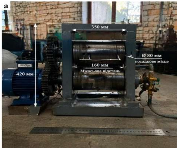
Рисунок 2.10 – Експериментальна установка для прокатування з підігрівом інструменту: а – загальний вигляд; б – фрагмент роботи газових пальників
