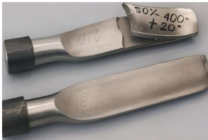
Рисунок 2.29 – Характер деформування заготовок із алюмінієвого сплаву Д16+SiC при різних теплових режимах інструменту:
